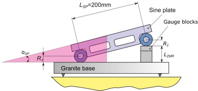
Figure 3. Tilt angle etalon.
