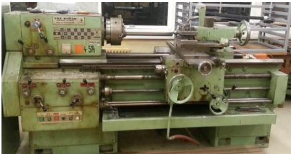
Figure 3. Universal center lathe SU 50
